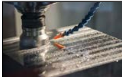
Fresatura ad alti avanzamenti
