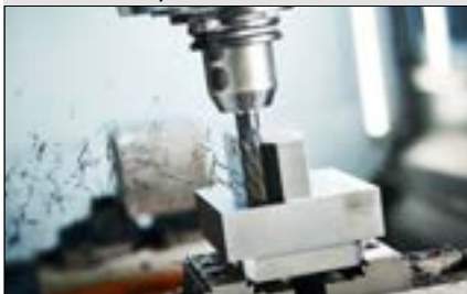
Fresatura di spallamenti
